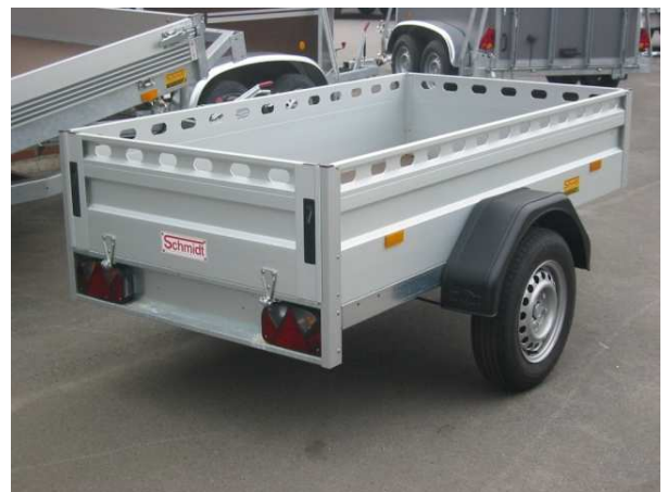
Alu-Bordwände mit Lochreling, 400mm
