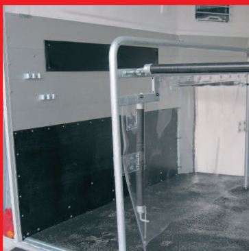
Trittschutz PVC an Seitenwänden
